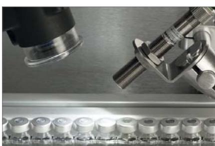
Verschlusskontrolle mittels Vision Sensor und Punktbeleuchtung (BEK-PM12-G5T-BS)
