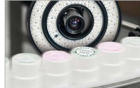
Hochgeschwindigkeitsetikettenkontrolle mittels geblitzter Ringbeleuchtung (BE-R...)
