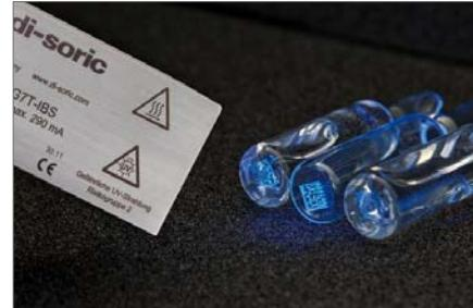
Anzeigen unsichtbar aufgebrachter Track & Trace Informationen im Pharmabereich mittels UV-Licht
