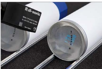
Codeprüfung mittels Codeleser und Punktbeleuchtung während der Fertigung (BEK 1-P...)
