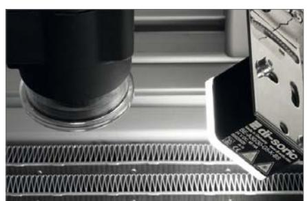
Produktkontrolle mittels Vision Sensor und Auflichtbeleuchtung (BE-A30/30-G5-K-BS)
