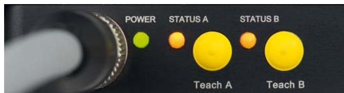
Helle Ausgangs- und Betriebsspannungs-LEDs signalisieren deutlich die Ausgangszustände und helfen bei der einfachen Inbetriebnahme der Geräte mittels Teach-Tasten.
