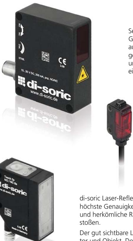
Sender und Empfänger befinden sich im gleichen Gehäuse. Der Empfänger erfasst den vom Sender ausgestrahlten und von einem Reflektor zurückgeworfenen Laserstrahl. Selbst ein kleines Objekt unterbricht diesen feinen Laserstrahl und führt zu einer Änderung des Ausgangssignals.
