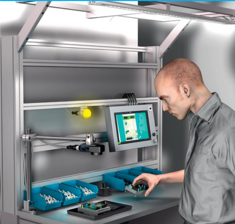
Während des Montageprozesses leuchtet die Signalleuchte gelb, bei richtiger Umsetzung des Montageschrittes leuchtet sie grün und das System leitet den nächsten Schritt ein, um neue Vorgaben zu machen. Tritt jedoch ein Fehler bei der Montage auf, so wird dies unmittelbar mit entsprechenden Hinweisen zur Korrektur mittels der rot leuchtenden (ggf. blinkenden) IO-Link Signalleuchte angezeigt.
