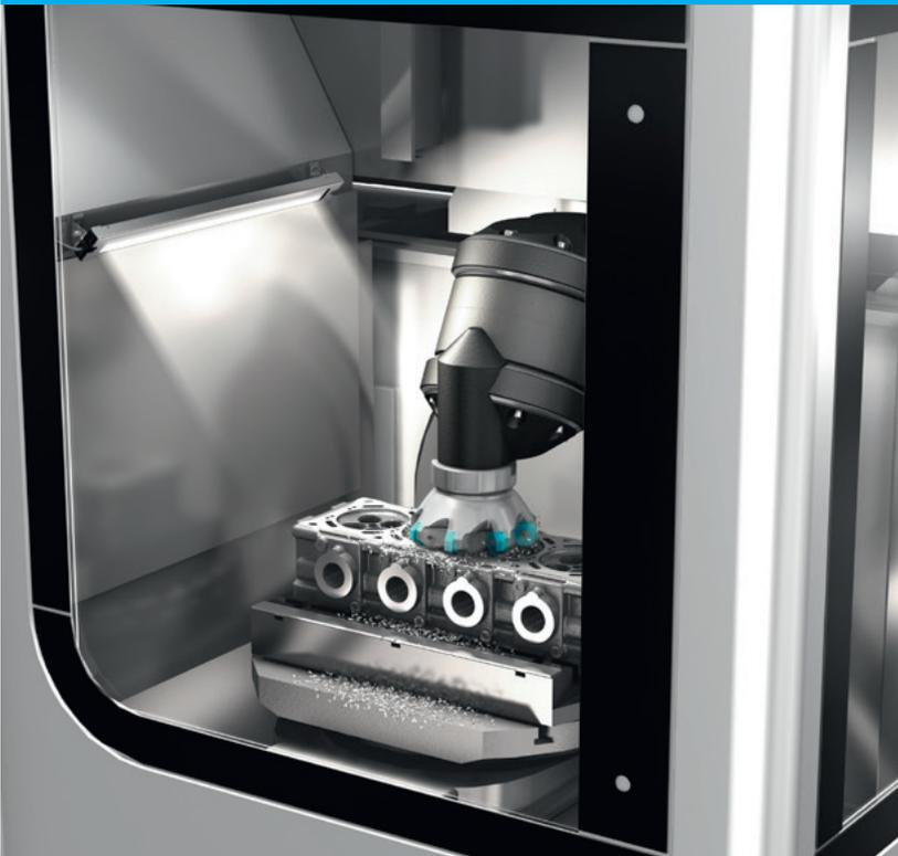
Die MB-NP stellt aufgrund ihrer Beständigkeit gegenüber dem Beschuss von heißen Spänen eine optimale Lösung zur Ausleuchtung in rauen Arbeitsumgebungen dar. Durch das schlanke Design sind die Maschinenleuchten MB-NP optimal in beengten Einbausituationen.
