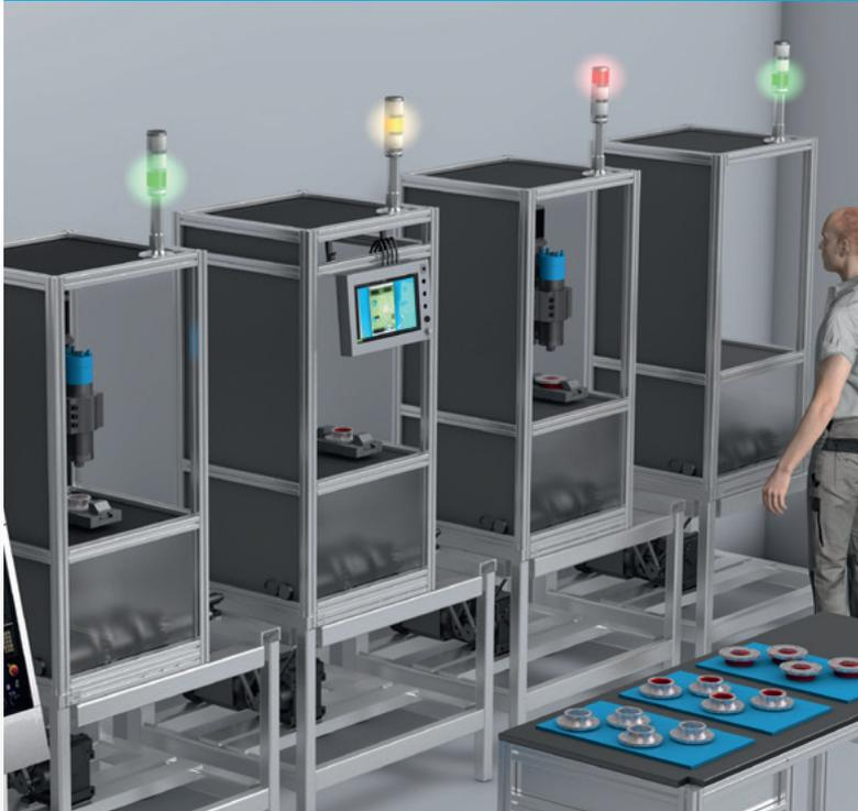
Unsere SBT-F signalisiert dem Bediener einfach den Maschinenzustand. Die SBT-F ist mit ihren fest zugewiesenen Farben pro Segment sofort einsatzfähig. Der Signalton ertönt sobald der Prozess abgeschlossen ist.
