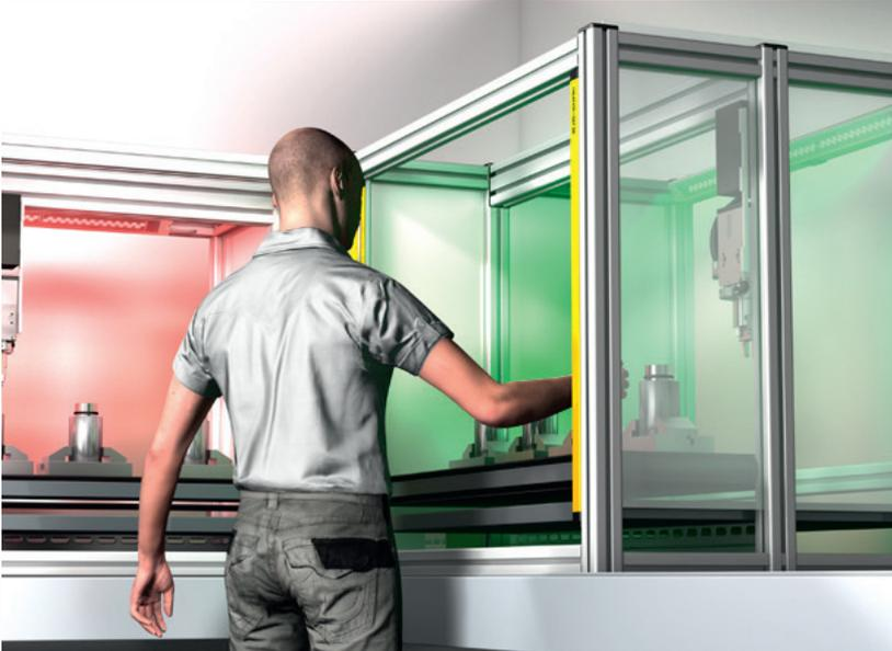
Wenn in einer Bearbeitungszelle ein Werkstück bearbeitet wird, kann die SB-RGB als optische Gefahrenanzeige eingesetzt werden. Eine rot beleuchtete Zelle zeigt eine Gefahr für den Bediener an. Wenn die Zelle grün leuchtet, kann der Bediener das Werkstück aus der Zelle entfernen. Damit können Fehlgriffe vermieden und die Anlagenverfügbarkeit erhöht werden.
