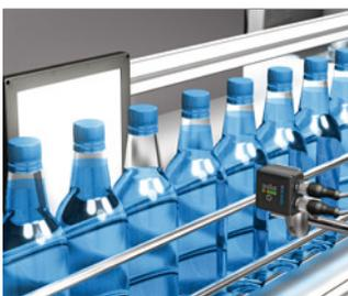
Füllstandskontrolle in einer automatischen Abfüllanlage
