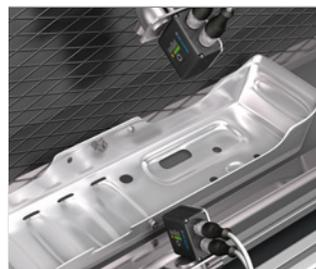
Merkmale und Vollständigkeit eines Werkstücks kontrollieren
